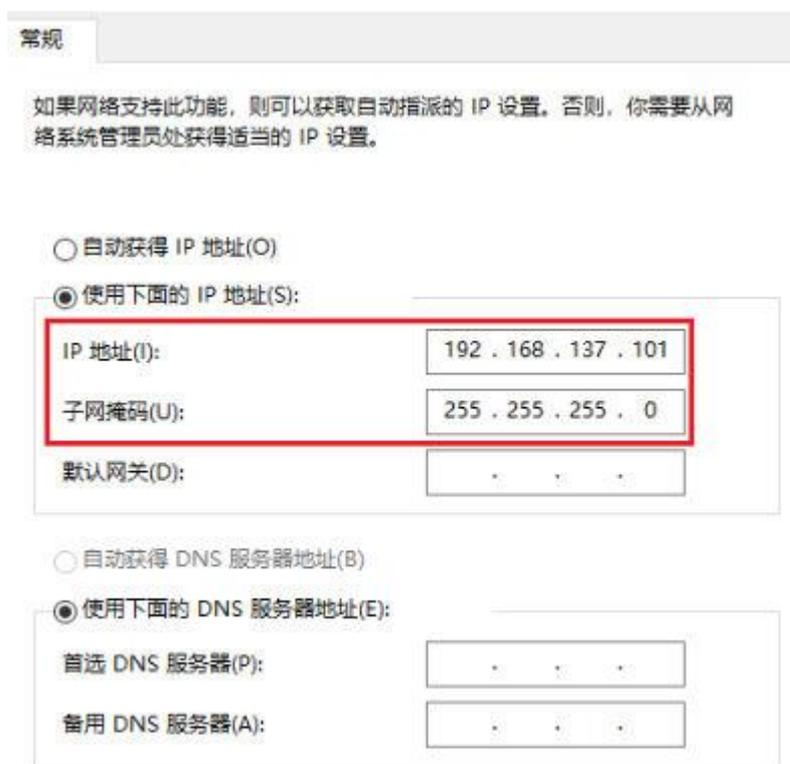
图 5-4 设置 PC 网口 IP 地址界面图
