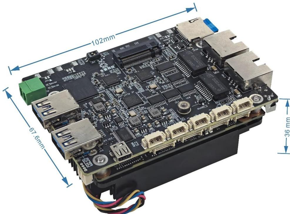
图 1-2 尺寸图 (单位: mm)
