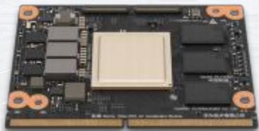
Atlas 200I A2 加速模块可以在边端侧实现目标识别、图像分类等AI应用加速，广泛用于智能边缘设备、机器人、无人机、智能工控等边端侧AI场景。
