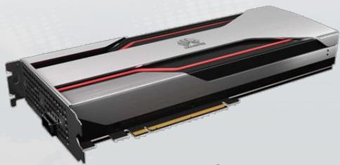
Atlas 300T Pro 训练卡配合服务器，为数据中心提供强劲算力的AI加速卡，单卡可提供最高280 TFLOPS FP16 算力，加快深度学习训练进程。Atlas 300T Pro 具有最强算力、最高集成、最快带宽等特点，满足互联网、运营商、金融等需要人工智能训练以及高性能计算领域的算力需求。
