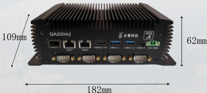
QA200A2 Atlas 200I A2智能小站是一款面向AI算法部署和应用开发的智能计算小站产品，具有硬件接口丰富、参考代码和算法模型丰富、工具全流程覆盖等特点，适合行业工程师使用，满足视频图像分析、自然语言处理、机器人、智能车等多个领域的需求。
