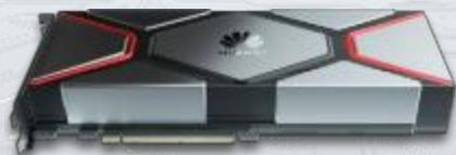
Atlas 300T A2 训练卡配合服务器，为数据中心提供强劲算力，单卡可提供最高280 TFLOPS FP16算力，加快深度学习训练进程。Atlas 300T A2具有超强算力、高度集成、高速带宽等特点，满足教育科研、智慧城市、金融等需要人工智能训练的算力需求。
