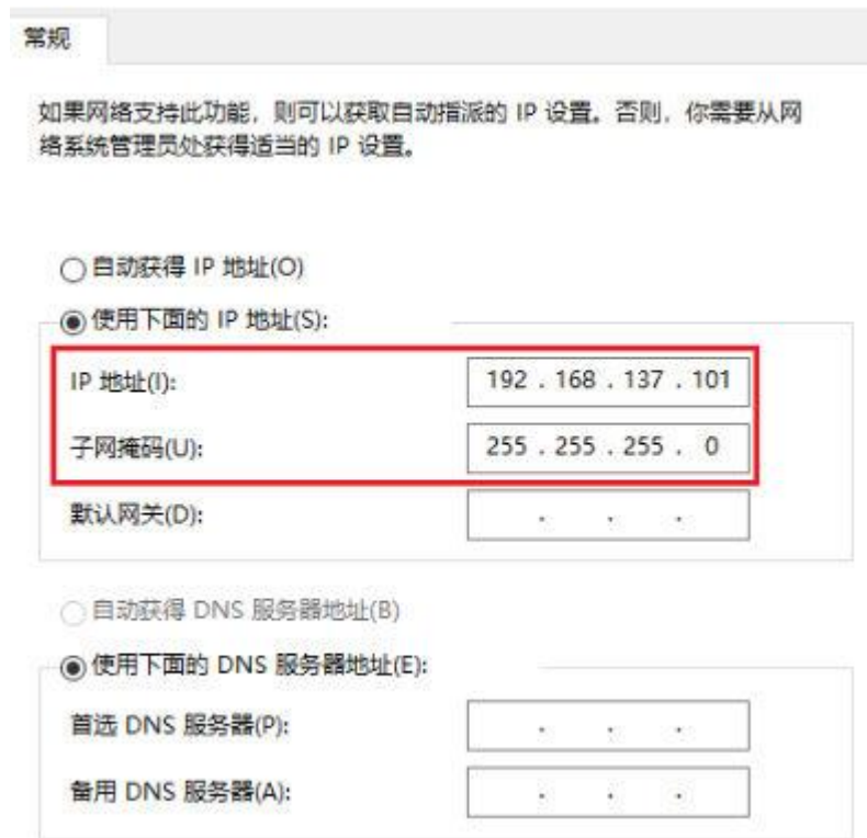
图 5-4 设置 PC 网口 IP 地址界面图
