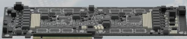
Atlas 200I SoC A1是面向边缘推理服务器市场的一款主板，融合“AI、CPU、视频编解码”于一体”。该主板为全高全长（10.5英寸）PCIe 标卡形态，可以适配1U/2U机箱，支持客户开发自有品牌的整机，可广泛应用于OCR识别、目标识别、搜索推荐、内容审核等诸多AI应用场景。
