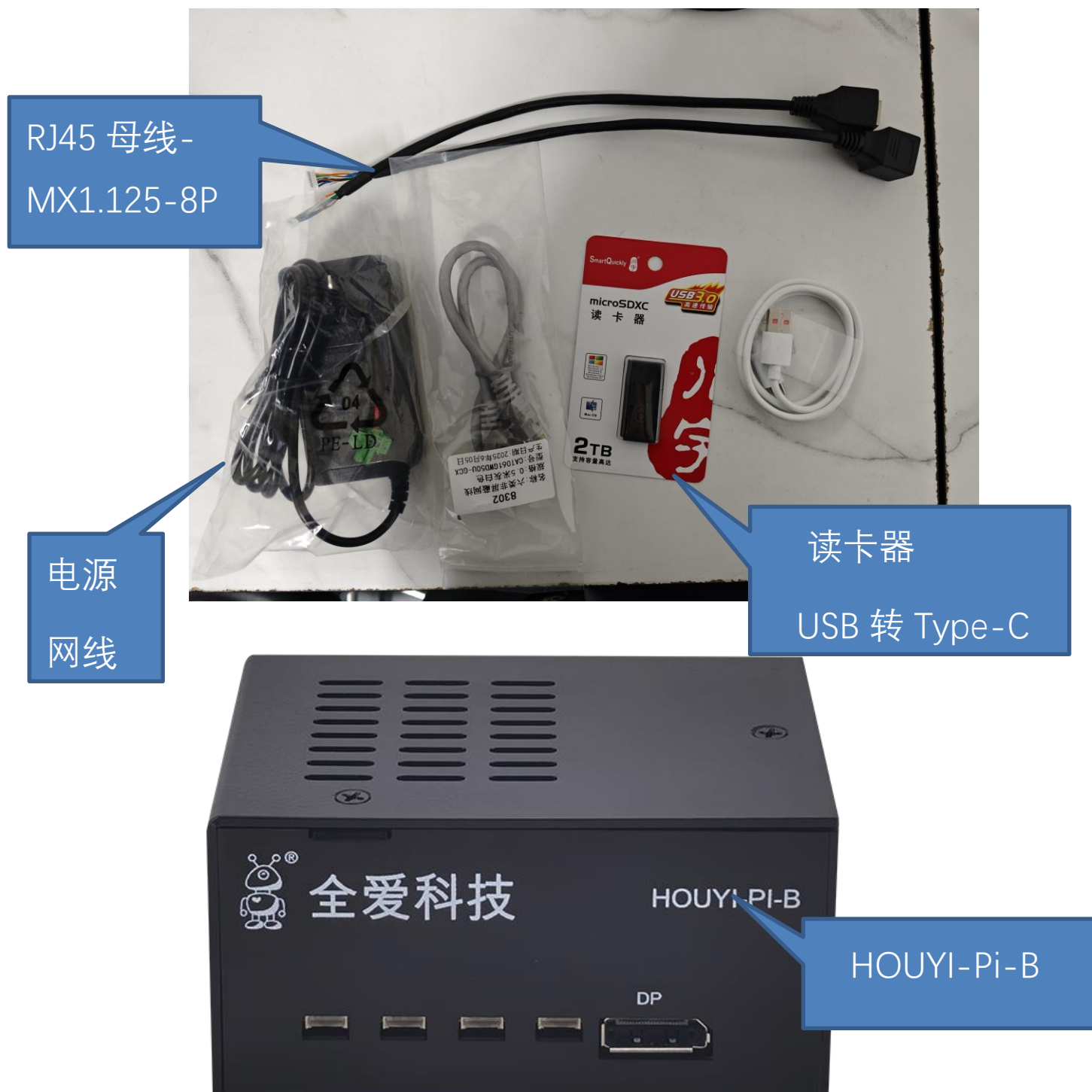
如图 1-1 所示为后羿智盒最简配置的相关硬件
