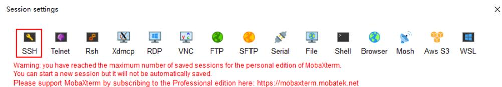
**步骤4** 根据硬件连接方式填写开发者套件连接PC的接口实际IP地址（[4 一键制卡](#)中配置的IP地址），勾选“Specify username”选项，填写用户名（以root为例）。图示以192.168.0.2为例，请根据实际修改。
