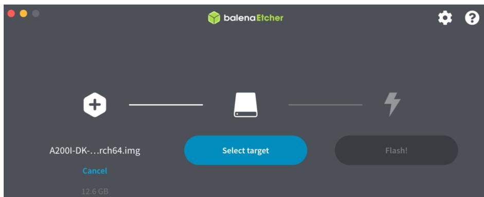
2. 单击Etcher软件界面“Select target”，勾选[格式化SD卡](#)中完成格式化的设备，单击“Select 1”选择，如[图4-21](#)所示。
