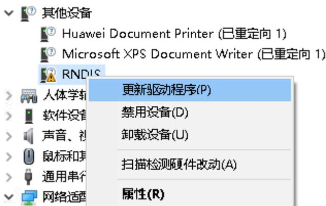
步骤4 在弹出的“更新驱动程序 - RNDIS窗口”中选择“浏览我的计算机以查找驱动程序软件(R)” ，然后选择“让我从计算机上的可用驱动程序列表中选择(L)”。
