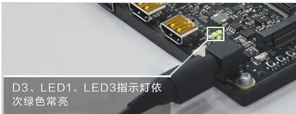
上电启动后开发者套件以太网口（以eth1网口为例）指示灯绿色常亮，黄灯闪烁，表示连线正常。
