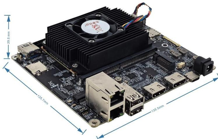
图 1-2 尺寸图 (单位: mm)
