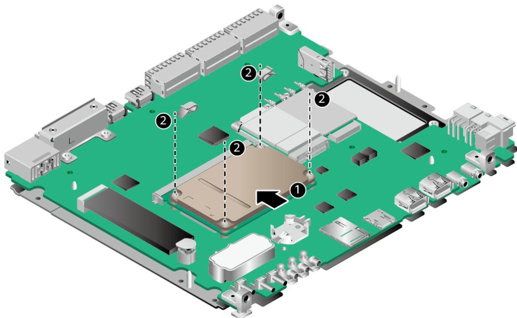
步骤3 使用M3.0十字螺丝刀拧紧4个M3x16的组合螺钉，如图图6-4所示。
