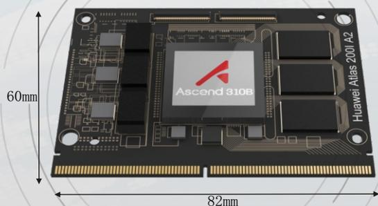
Atlas 200I A2 AI 加速模块 可以在边缘侧实现目标识别、图像分类等，广泛用于智能摄像机、机器人、无人机、无人车等边缘侧AI场景。
