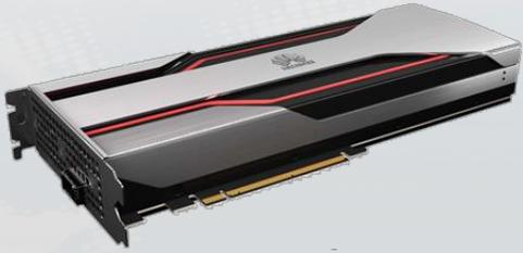
华为Atlas 300T Pro 训练卡配合服务器，为数据中心提供强劲算力的AI加速卡，单卡可提供最高280 TFLOPS FP16 算力，加快深度学习训练进程。Atlas 300T Pro 具有最强算力、最高集成、最快带宽等特点，满足互联网、运营商、金融等需要人工智能训练以及高性能计算领域的算力需求。
