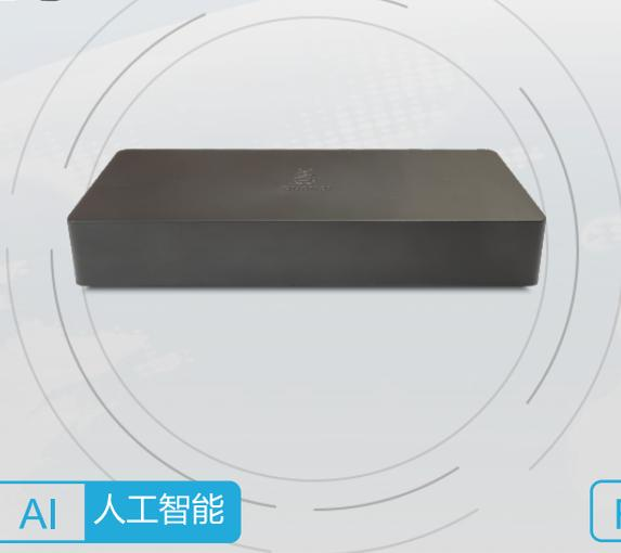
QA200RC 开发者套件是一款高性能AI应用开发板，支持HUAWEI公司Ascend Atlas200的RC和EP可切换模式开发套件，集成了昇腾310 AI处理器，提供22T算力，8GB DDR4，方便用户快速开发、快速验证，可广泛应用于开发者方案验证、高校教育、科学研究等场景。
