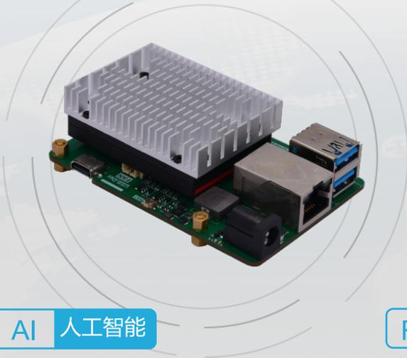
Houyi2001 开发板是一款高性能AI应用开发板，支持HUAWEI公司Ascend Atlas200的RC模式，基于昇腾310 AI处理器，提供22T算力，8GB DDR4，是一款方便用户快速开发、快速部署的开发工具。可广泛应用于开发者方案验证、高校教育、科学研究、智慧安防、智慧交通、智能制造等场景。
