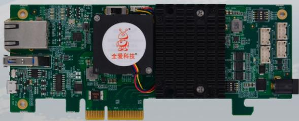
QA200EP 推理卡，基于昇腾310 AI处理器，单卡算力可达22TOPS INT8，支持12路高清视频实时分析，采用PCIe x4标准接口，支持 Ascend Atlas200 EP开发模式。
