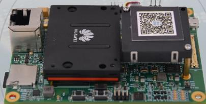
QA200 开发板是一款高性能AI应用、机器人视觉应用的开发板，集成海思Hi3519A和昇腾310AI处理器，支持双路4K实时视频分析，为机器人智能化提供实时视频分析能力，提升机器人智能化水平，方便用户快速开发、快速验证，可广泛应用于开发者方案验证、高校教育、科学研究等场景。
