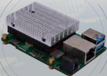
HOUYI2001 开发板是一款高性能AI应用开发板，支持HUAWEI公司Ascend Atlas200的RC模式，基于昇腾310 AI处理器，提供22T算力，8GB DDR4，是一款方便用户快速开发、快速部署的开发工具。可广泛应用于开发者方案验证、高校教育、科学研究、智慧安防、智慧交通、智能制造等场景。
